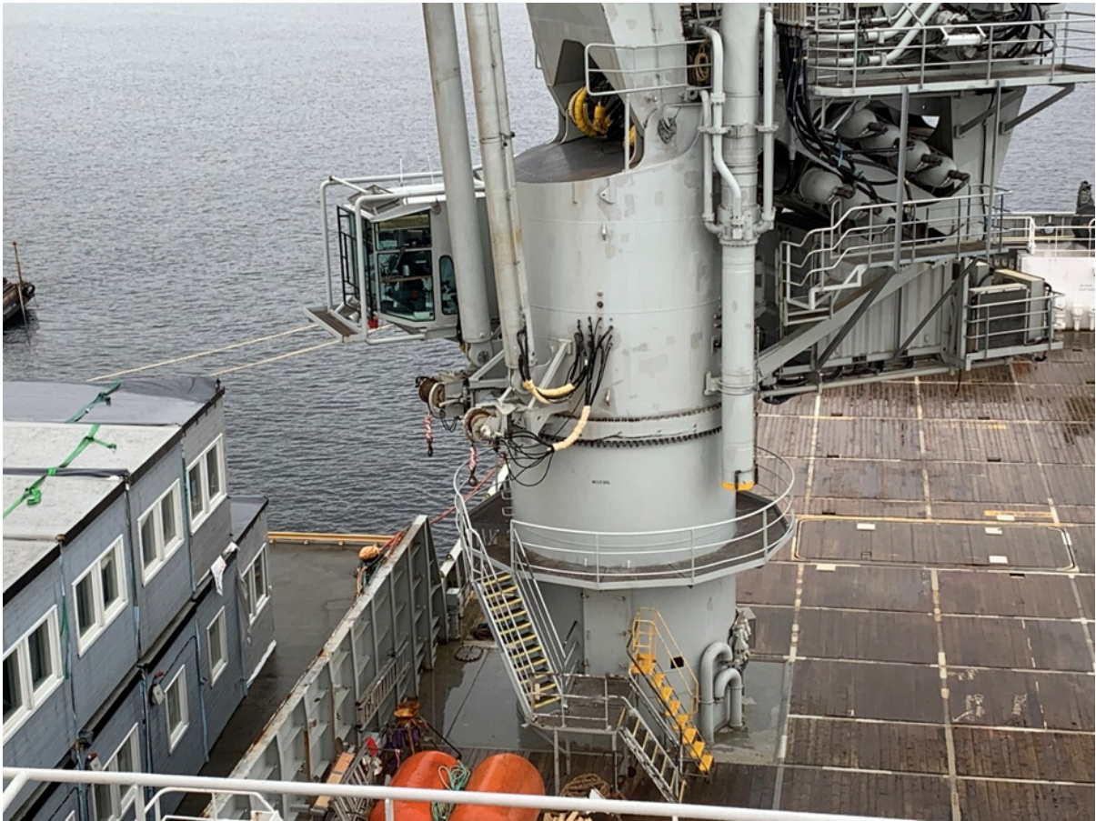
Bildet er gitt av Kristian Økland, og viser en typisk posisjon for en tigger-vinsj som er montert på en kran.
