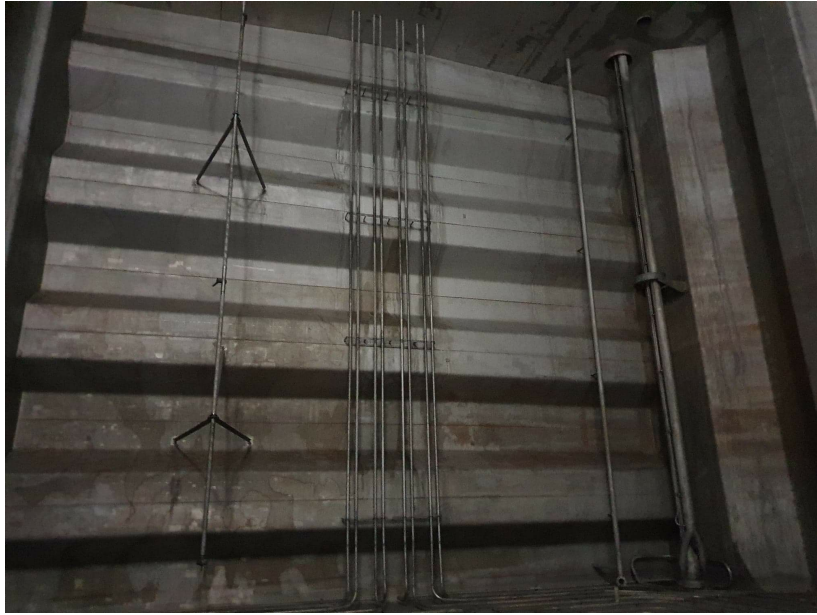
Bildet er gitt av Jan S. Kyrkjeide, og viser heatlinen ned til tanken, bilde er fra en kjemikalietanker og vi ser fire sløyfer.
