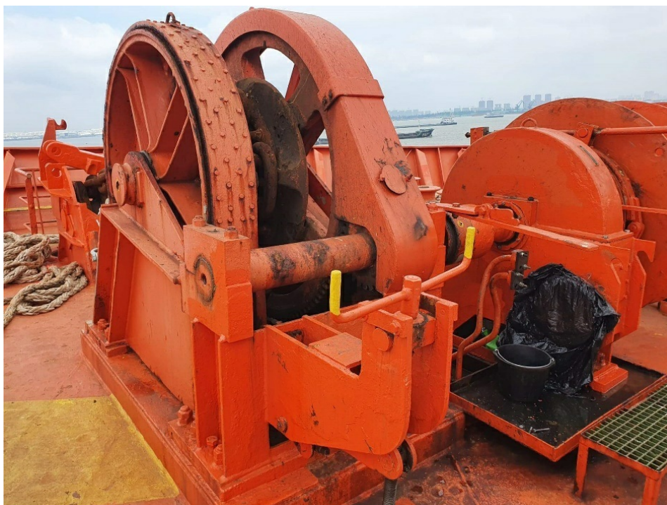
Bildet er gitt av Jan S. Kyrkjeide, og viser ankervinsjen, denne vinsjen er kombinert med fortøyningsvins og har brestene på samme vinsj.
