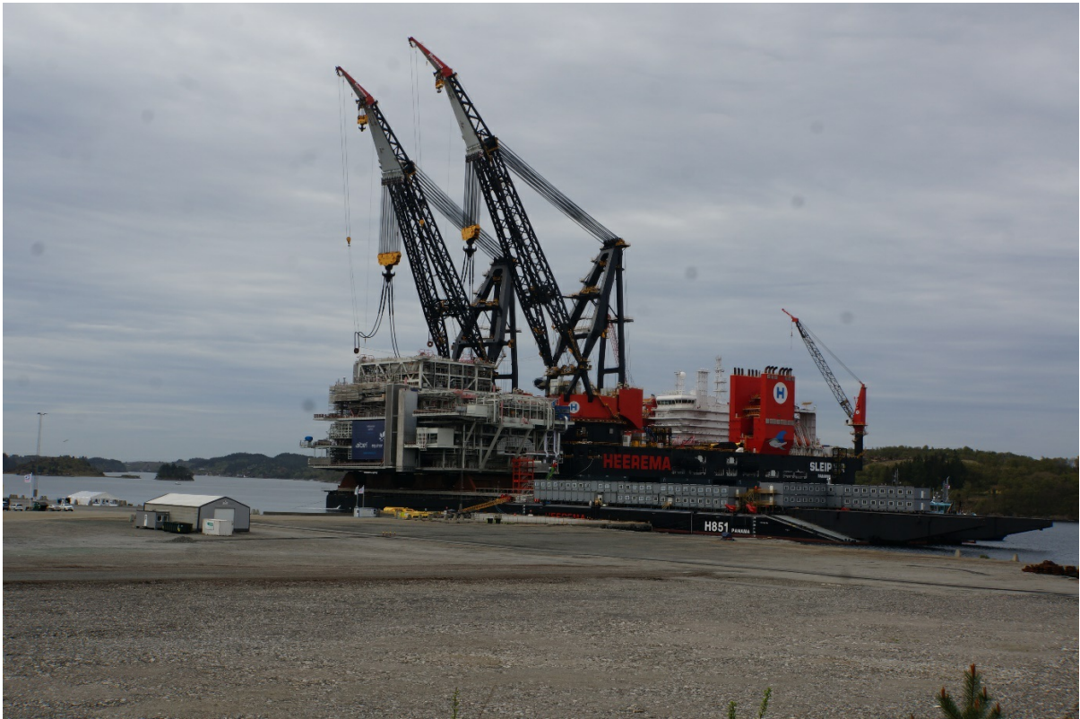
Bilde av Heerema Sleinir, som løfter på plass en av delen til Johan Sverdrup. Kapasitet 10 000 tonn på hver krane.
