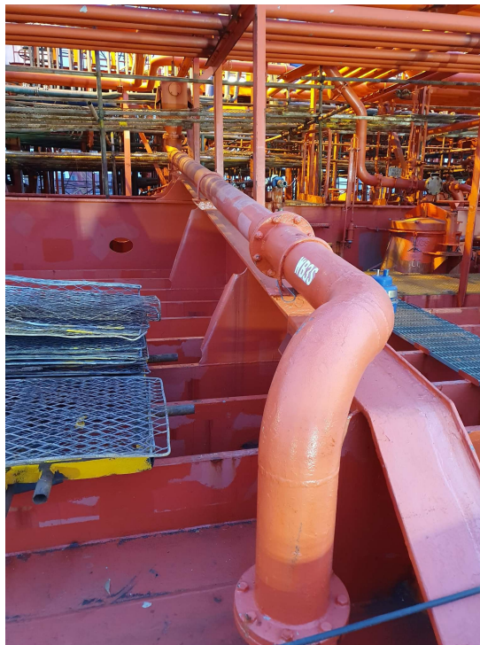
Bildet er gitt av Jan S. Kyrkjeide, og viser ballast luftelinen som går fra oppunder dekk til ventilasjonshatten.
