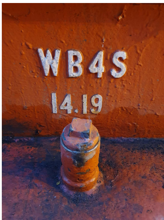
Bildet er gitt av Jan S. Kyrkjeide, og viser peilerør for ballasttank WB4S.
