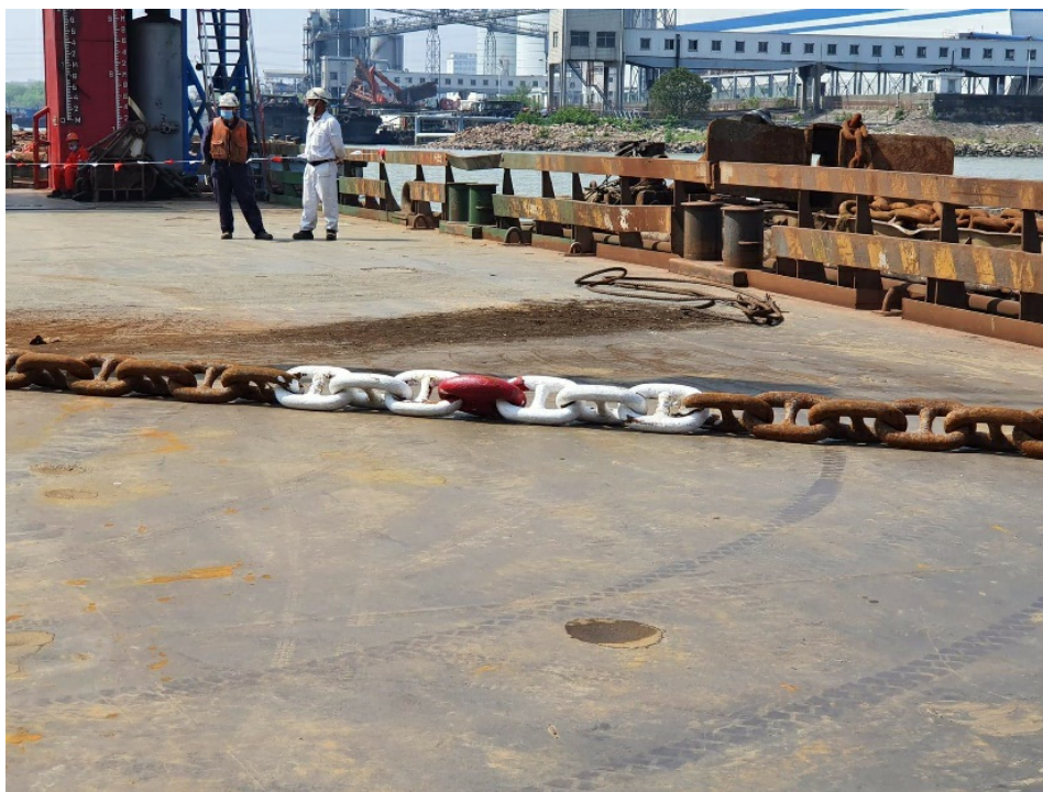
Bildet er gitt av Jan S. Kyrkjeeide, og viser hvordan en markerer tre lås.
