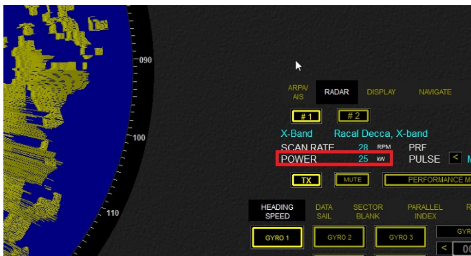
Figur 15 Utsendt effekt på Radar
