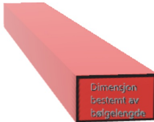
Figur 24. Bølgeleders dimensjon bestemt av bølgelengden
