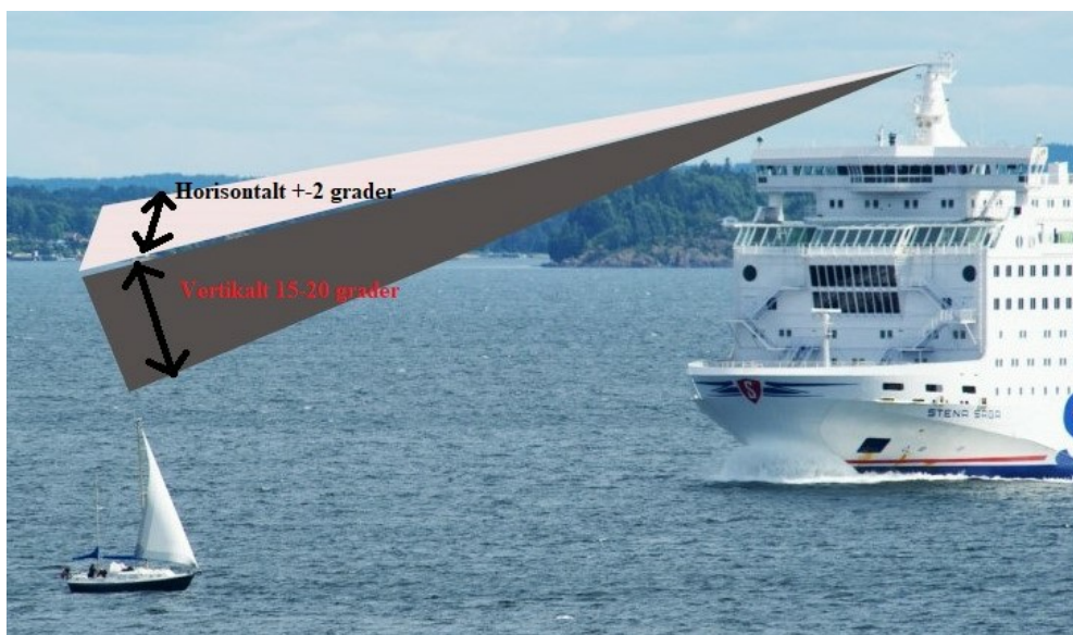
Figur 23 Horisontal og vertikal strålebredde Foto: Magne Klann/Norsk Maritimt Forlag AS
